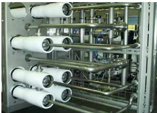
图 4. 反渗透系统照片。来源: VWS Deutschland GmbH - BERKEFELD
