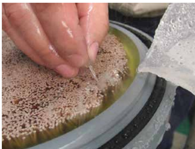
图 9-4. 在出现连续气泡的地方标出发生泄漏的膜丝
